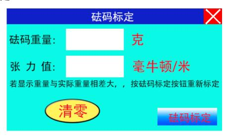
1.1 挂上铂金环和电感磁铁后,仪器"砝码重量"正常显示 0.050g 以内,如果数值偏大或低于 0g,请检查扭力丝和电感磁铁位置(是否在电感中心)。
