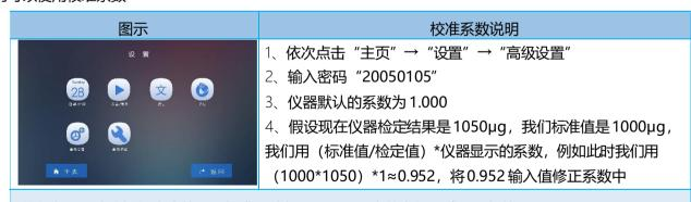
以上步骤不建议初级客户使用,校准系数仅限工厂和用户的高级调试工程师使用
