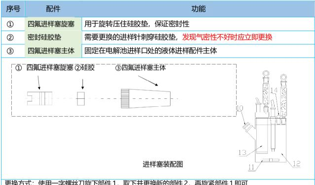
更换方式: 使用一字螺丝刀旋下部件 1, 取下并更换新的部件 2, 再旋紧部件 1 即可
